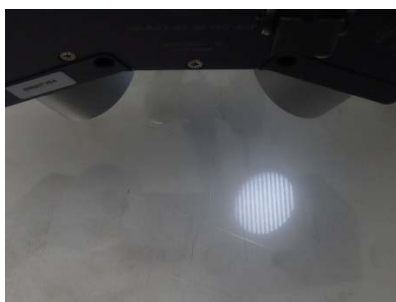
Датчик блеска GLAST-85-30°/30°-DIF-1.0/1.0 - все три настройки с ПК-интерфейсом STRUCT-Scope
